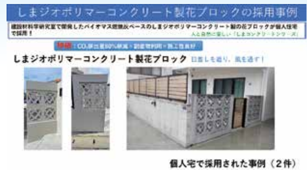
▲「しまジオポリマーコンクリート」が花ブロックの材料に採用（製造先）南大城ブロック工業
