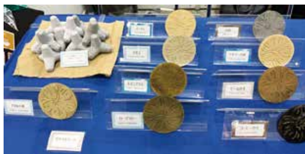
▲ギンネムやレモングラスなど、多様な植物資源を利用した「植物性コンクリート」を開発中
