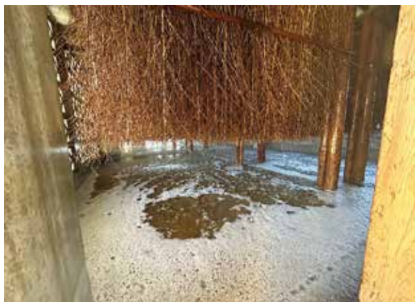
▲タワーにつるした竹を利用して海水をろ過する
