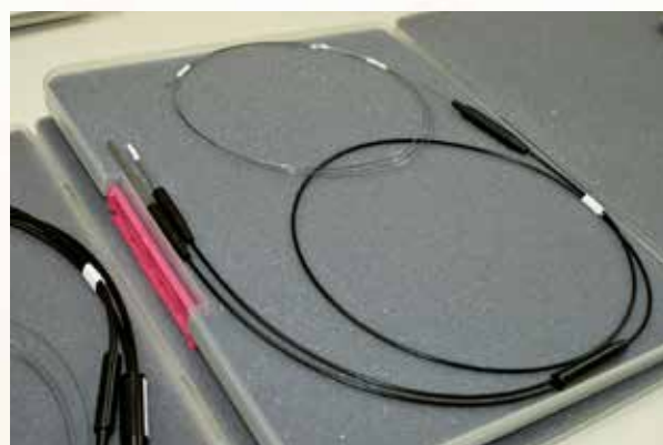
▲最小外径0.8mmのファイバー内視鏡の開発
